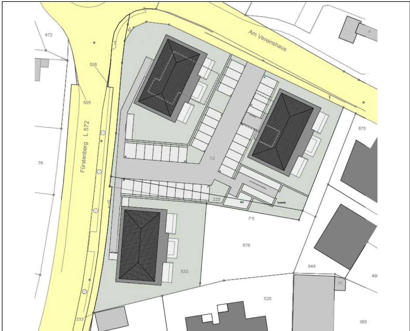
Abb. 1: Lageplan zur Errichtung von drei Mehrfamilienhäusern – Variante 7.4
