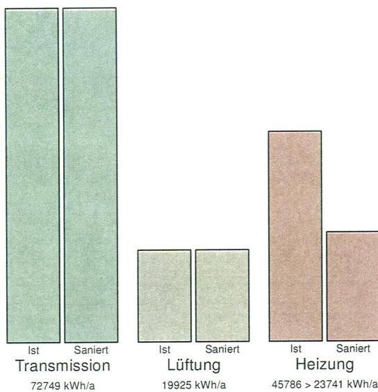
Der derzeitige Endenergiebedarf von 111154 kWh/Jahr reduziert sich auf 89296 kWh/Jahr. Es ergibt sich somit eine Einsparung von 21858 kWh/Jahr, bei gleichem Nutzerverhalten und gleichen Klimabedingungen.
