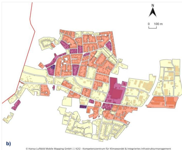
Abb. 33b, zeigt einen Rückgang des Heizwärmebedarfs bis 2030 und in mehreren Baublocken eine Verschiebung der Netzeignung in Richtung Wärmenetz mit niedrigeren Vorlauftemperaturen.
