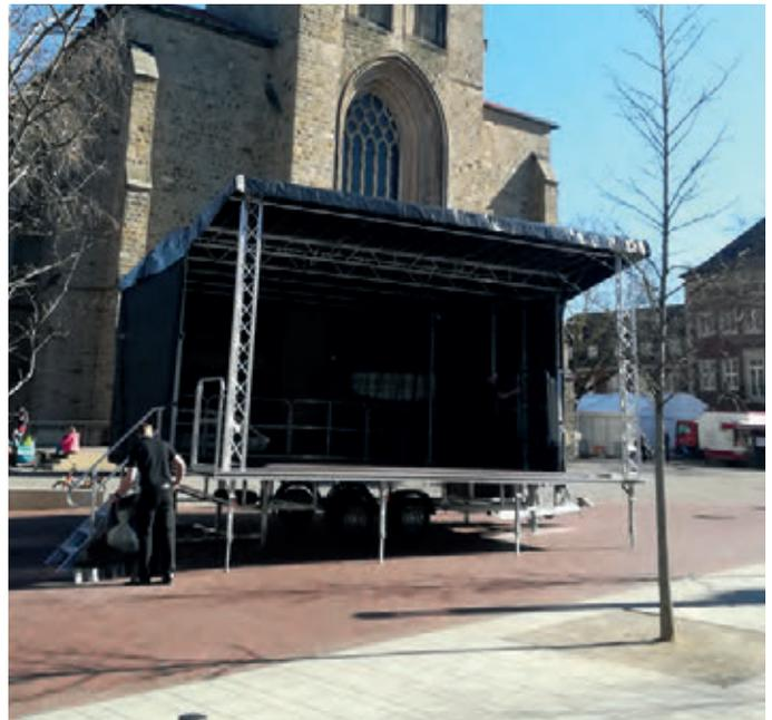
Weitere Infos zu dem Projekt und zu den technischen Details der maximal 6,80 Meter breiten und 6,30 Meter tiefen Bühne gibt es unter: [www.berkel-schlinge.de/projekte/Mobile\\_Trailer\\_Buehne.php](http://www.berkel-schlinge.de/projekte/Mobile_Trailer_Buehne.php).
